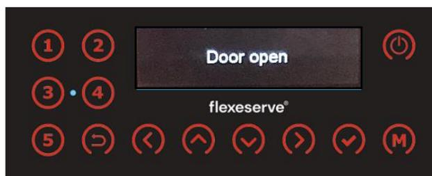
Une alarme sonore retentira après 10 secondes si la porte n'a pas été fermée correctement après le chargement des produits. Cela permet de notifier que la porte est restée ouverte plus longtemps que le temps recommandé et d'éviter les pertes de chaleur de l'unité, en veillant à ce que la température du produit soit maintenue.
