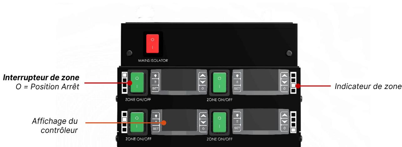
Lorsqu'une zone individuelle est mise à l'arrêt, l'affichage du contrôleur et l'interrupteur de puissance de zone ne seront plus allumés et la zone sera éteinte.
